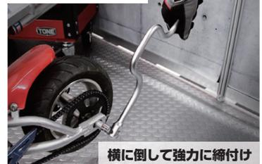
横に倒して強気に締付け
