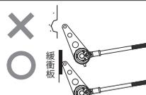
反力受取り付けボルトの破損・変形やレンチの破損、焼付きなどの原因になります。
